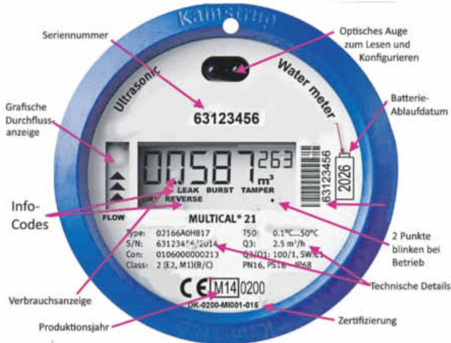
Die Info-Codes verraten Ihnen so einiges. Beispielsweise sehen Sie, wenn ein Leck in Ihrer Hauswasserversorgung besteht. In diesem Fall blinkt die Anzeige „LEAK“ (Leck) auf. Sollten Sie selbst keinen tropfenden Wasserhahn oder laufenden Toilettenspülkasten entdecken, machen Sie einen Termin mit Ihrem Installateur aus. Er wird Ihnen helfen, die Ursache zu finden und zu beheben.
