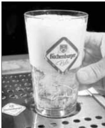
*Ausgeklügelte Technik: Eine Füllöffnung im Glasboden wird durch einen Magneten verschlossen. Setzt man das Glas auf die Zapfdüse, hebt sich der Magnet und das Bier kann von unten einfließen. Nach wenigen Sekunden ist das Bier mit guter Schaumkrone fertig. Nach dem Abheben von der Zapfdüse verschließt der Magnet im Boden das Glas*
