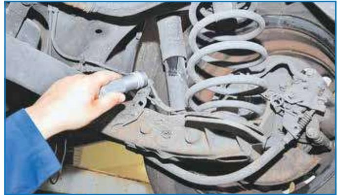
Sobald das Fahrverhalten in Kurven unsicher wirkt, die Lenkung flattrig ist oder die Seitenwindanfälligkeit spürbar zunimmt, sollte die Werkstatt die Dämpfer prüfen. Auch Geräusche beim Überfahren von Unebenheiten und ausgewaschene Stellen im Reifenprofil sind Indizien. Defekte Dämpfer beeinträchtigen die Spurstabilität und verlängern den Bremsweg. Viele Kfz-Werkstätten haben Prüfstände, welche die Leistungsfähigkeit der Dämpfer exakt messen. *pm*
